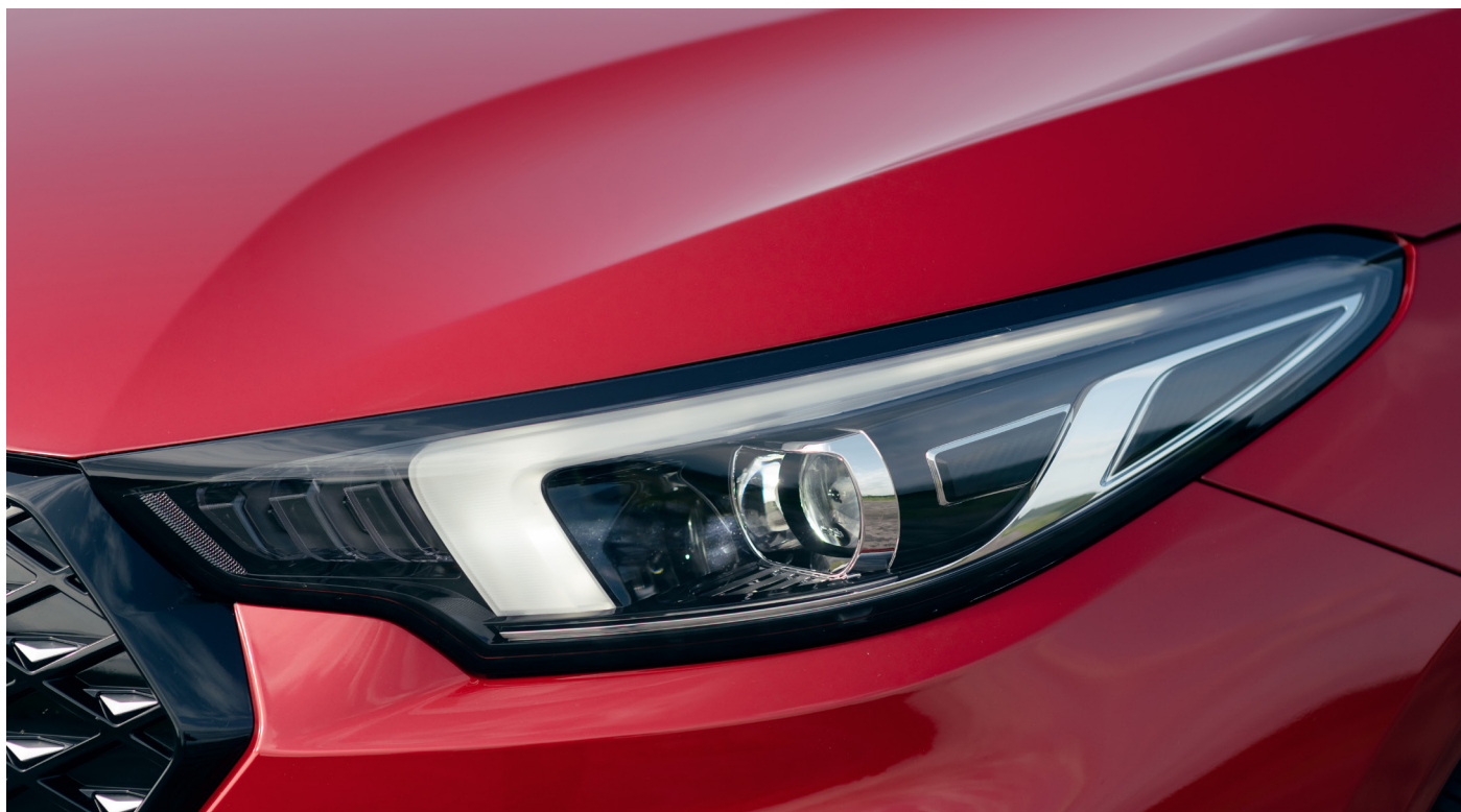
«Линзованные» светодиодные фары ближнего и дальнего света
